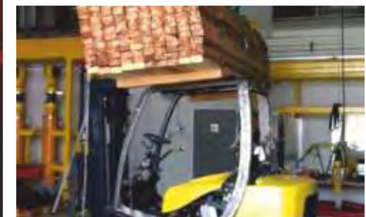
Alle Sicherheitsrahmen werden nach Vorschrift geprüft. All safety frames are checked according to regulations.
