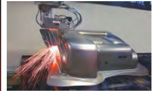
Ein Laserschnitt erstellt passgenaue Konturen. Laser-cutting creates exactly fitting contours.
