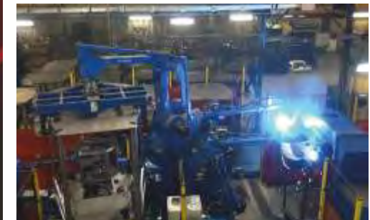
Roboter-Stationen schweißen komplette Kabinenstrukturen. Robot stations weld complete cab structures.
