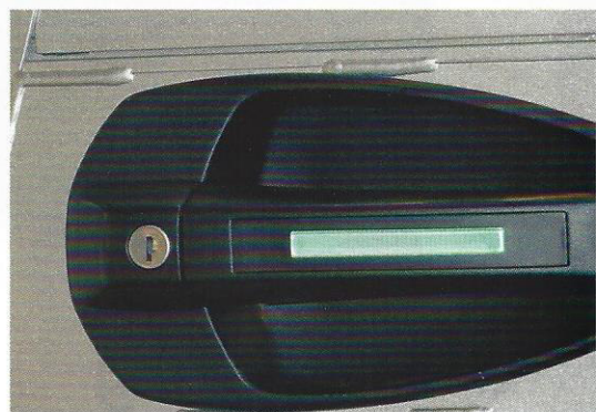
Diese Tür ist nicht verriegelt (grün), ein roter Balken signalisiert das Gegenteil.
