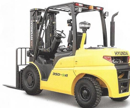
**Der Frontstapler 35D-9A von Hyundai hat eine Tragfähigkeit von 3,5 t und wird von einem 70 kW starken Kubota-Vierzylindermotor angetrieben**
