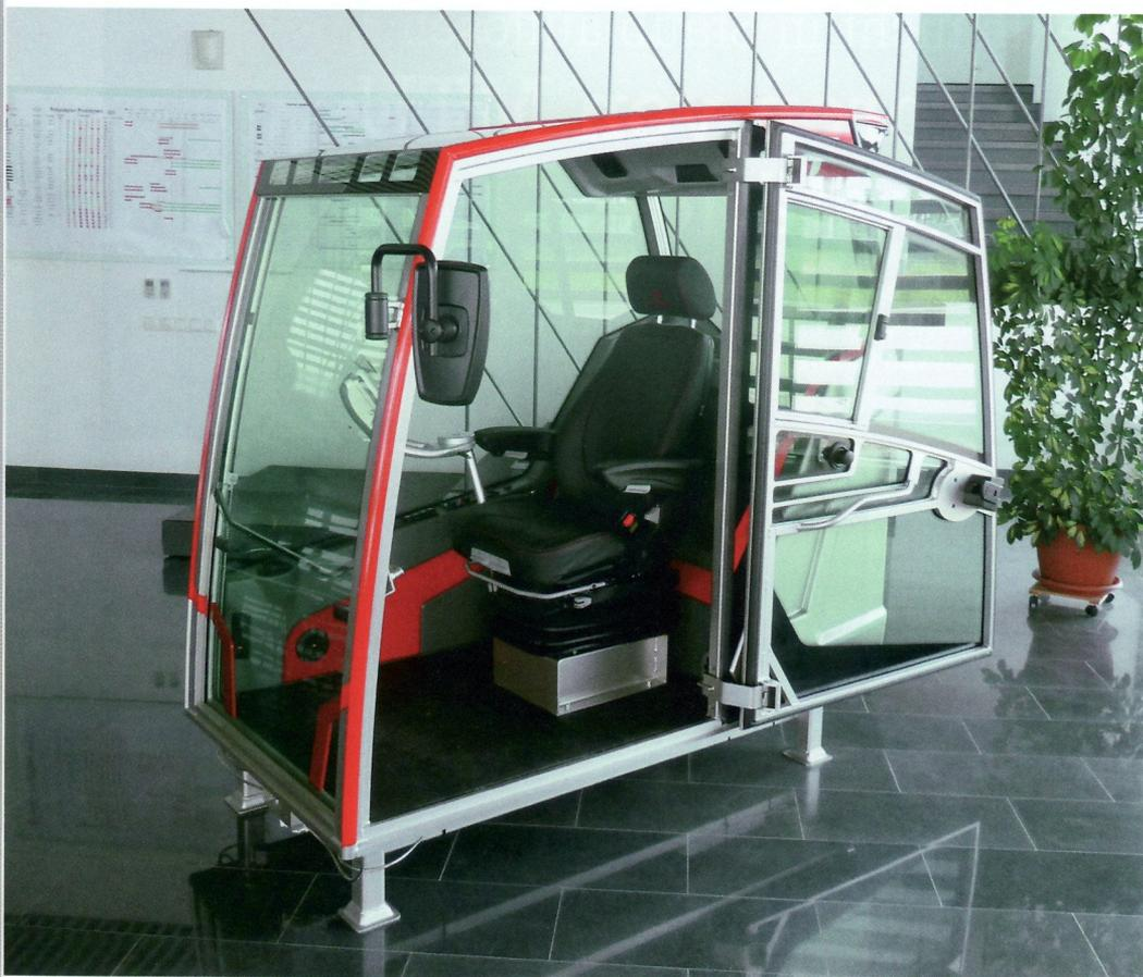
**Ausstellungsstück:** Die neue Leichtbaukabine war bereits im Frühjahr auf der bauma zu sehen, eine besonders leichte Konstruktion, deren Struktur komplett aus Aluminium besteht – natürlich werden die erforderlichen Sicherheitsprüfungen nach ROPS und FOPS trotzdem bestanden.
