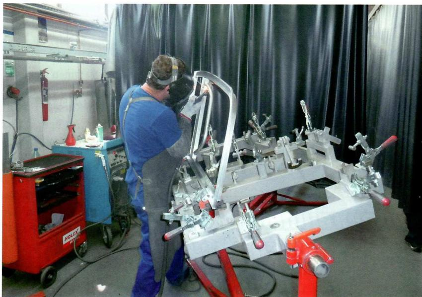
**Präzisionsarbeit:** Die genau zugeschnittenen und gebogenen Aluprofile werden vom Roboter zu Kabinenrahmen, Türen oder Schiebefenstern verschweißt – für kompliziertere Formen und präzise Einbauten sind hoch qualifizierte Schweißer zuständig.
